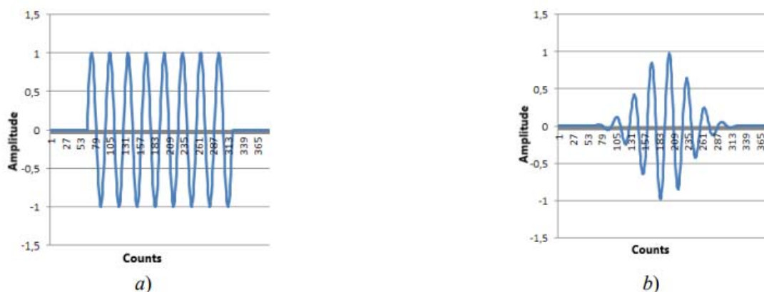
Рис. 3. Виды воздействующих сигналов (a, b). Синусоидальный сигнал с постоянной амплитудой и протяженностью 8 периодов (a), синусоидальный с амплитудой, меняющейся по нормальному закону, протяженностью 8 периодов (b)
