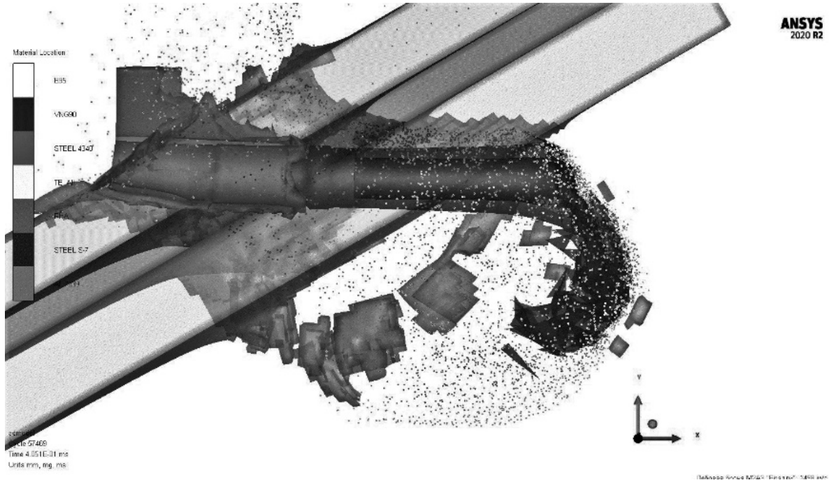
Рис. 4. Пробитие лобовой брони корпуса БМП М2А3
